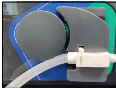
Figura 6 – Equipo de irrigação no frontal da Bomba 1
